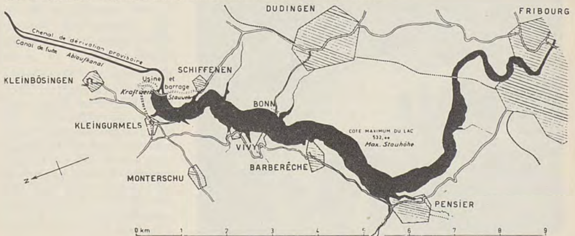
Bild 1: Allgemeine Projektanordnung: Stausee und -mauer, Werk, Abflusskanal
