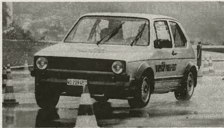
Les essais de freinage avec les nouveaux pneus larges Veith indiquent un chemin de freinage nettement réduit.
