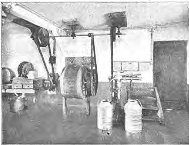
Abbild. 14. Elektrischer Antrieb in einer Käseerei. Vermitteltst einem an der Wand befestigten Motor der Maschinenfabrik Verlikon.
