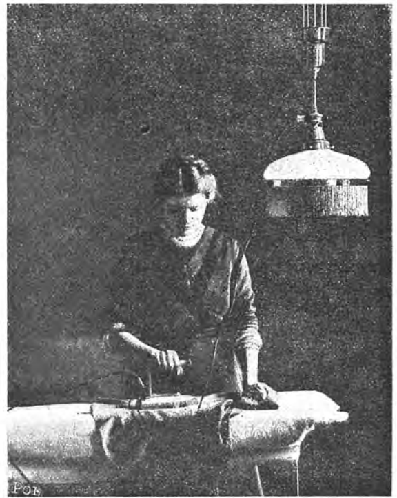
Abbildung 10. Elektrisches Bügeleisen. Durch Fassungsstecker an Zuglampe angeschlossen.
