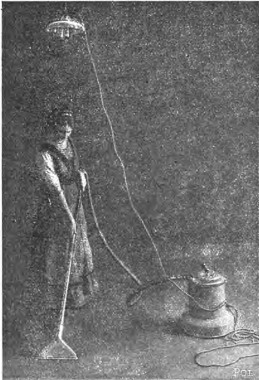
Abbildung 9. Staubsaugapparat. Mittels „Fassungsstecker“ an Lichtleitung.
