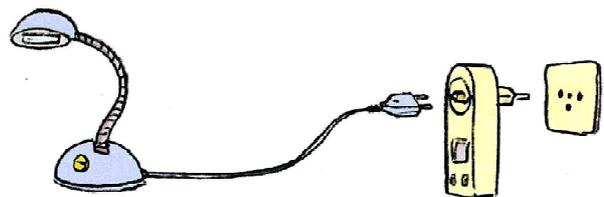
Es handelt sich um ein kleines Messgerät, das zwischen Steckdose und dem zu prüfenden Gerät angeschlossen wird. Die Anzeige gibt Auskunft über die Wirkleistung und die Menge der verbrauchten Energie während eines bestimmten Zeitraumes. So können verschiedene Geräte miteinander verglichen werden, der wirkliche Energieverbrauch von unregelmässig verwendeten Geräten herausgefunden oder der versteckte Energieverbrauch von vermeintlich abgestellten oder im Standby laufenden Geräten ermittelt werden.
