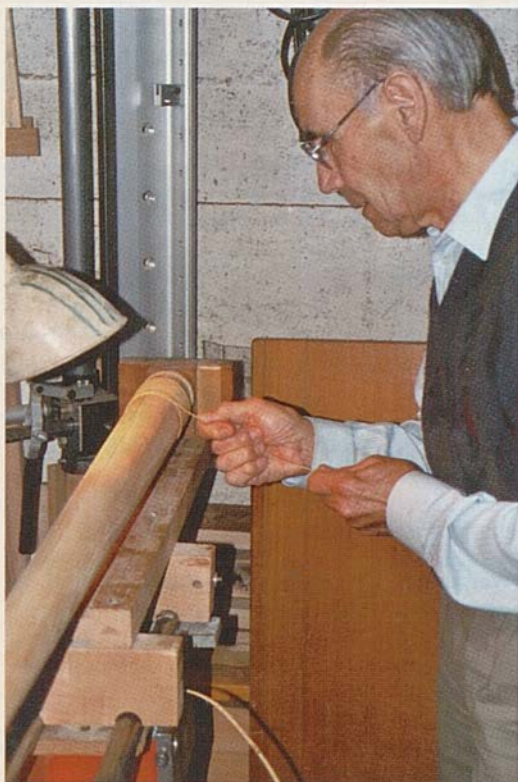
Die zusammengeleimten Rohrteile werden mit Meerrohr eingebunden.
