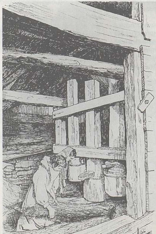
Bleuelmühle. Das Heben und Senken der fallenden Pochhämmer besorgt eine baumdicke hölzerne Horizontalwelle mit eingelassenen hölzernen Schnappzähnen. Die Welle selbst wird vom Wasserrad mittels einfacher Kraftübertragung in langsame Drehung versetzt.
