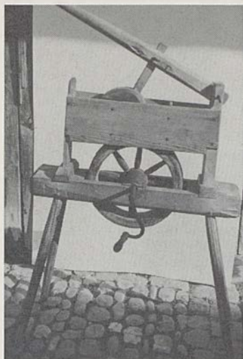
Mit der «Ämmermühle» wurde aus Kartoffeln Stärke zum Stärken der Wäsche gewonnen.
