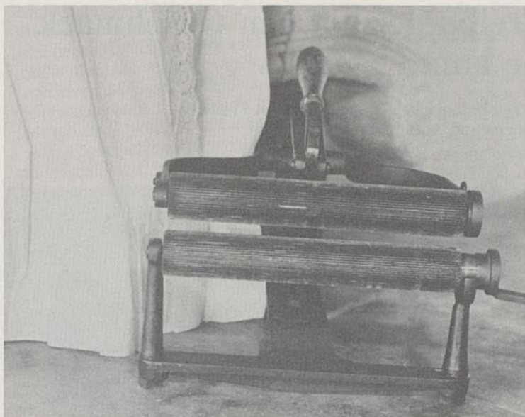
Mit dem Gaufrierapparat wurden vor allem «Trachtenmänteli» und Herrenhemden in viele feine Fältchen gelegt. Links vom Apparat ein fein gefälteltes «Trachtenmänteli».
