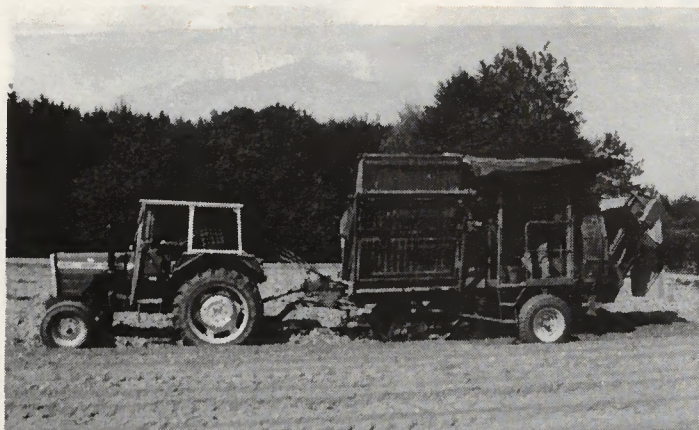
Une machine pour récolter et trier les pommes de terre.
