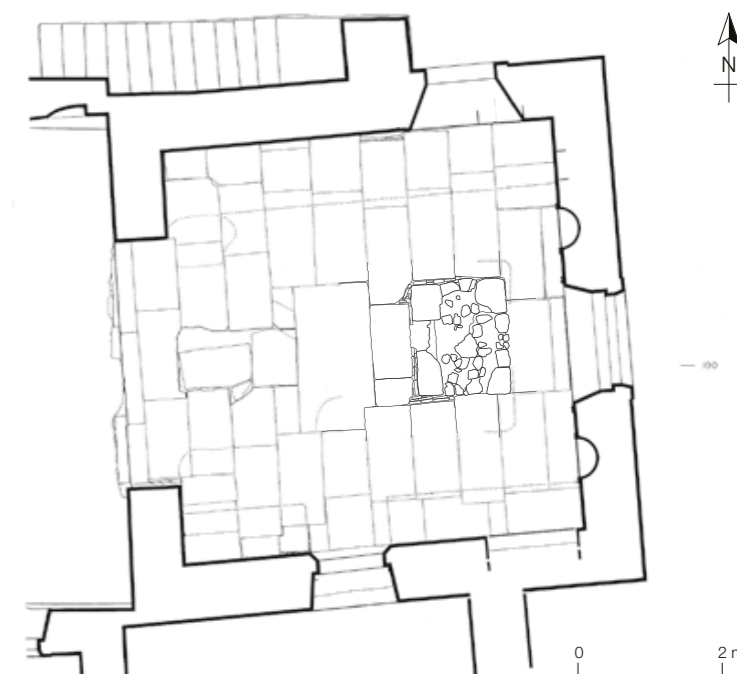
Fig. 42 Relevé du sol en dalles de molasse du chœur de la fin du XVIII e siècle sans doute, avec la base du maître-autel, les limites des traces d'usure le long des murs latéraux et l'emplacement d'une sépulture axiale, vraisemblablement celle du curé François-Xavier-Pierre Spicher (1827-1889).
