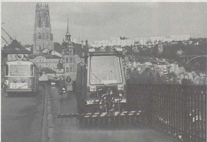
Boschung Pony mit Schwemmanlage, Schwemmbalken beidseitig ausfahrbar
