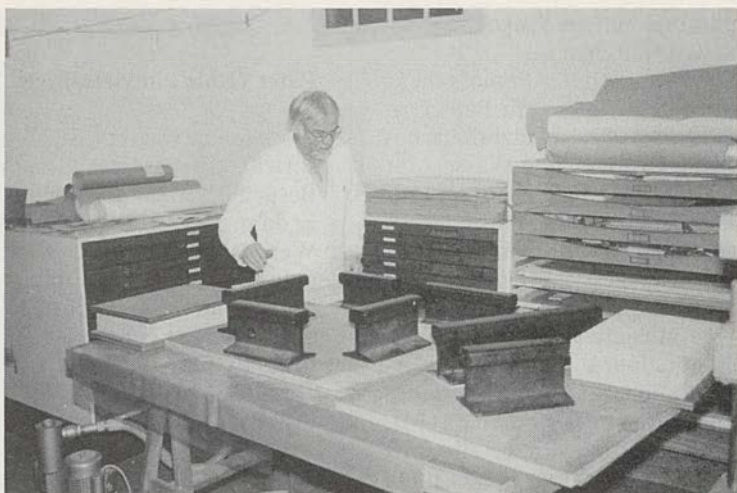
Unter den Schienenstücken auf dem Saugtisch trocknet ein aus Fragmenten zusammengestellter alter Grundbuchplan aus dem Jura.
