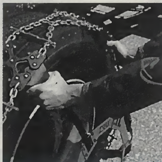
Déplier la chaîne, la saisir par deux guides à positionner sur le haut du pneu. Bien répartir le chemin de chaîne sur la bande de roulement du pneu.
