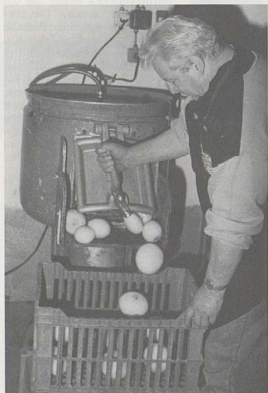
In der Schmirgel-Schälmaschine verlieren die Rüben ihre Haut. Trotzdem ist ihre Verarbeitung arbeitsintensiv.
