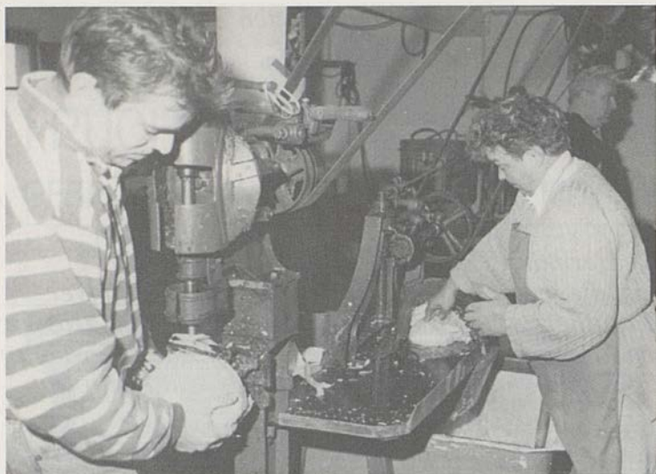
Nachdem Ernst Lauper-Egger (vorn) mit der Strunkbohrmaschine den Storzen entfernt hat, wandern die Kabisköpfe zum Hobeln zu Trudi Egger-Krebs (hinten).
