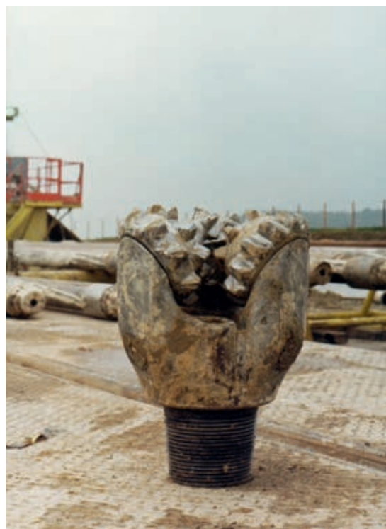
Der imposante Bohrkopf bohrte sich in einer Stunde neun Meter in die Tiefe. Nach 1970 Metern und 28 Tagen wurde die Erdölsuche ergebnislos eingestellt. Bild Archiv Gemeinde Böisingen
