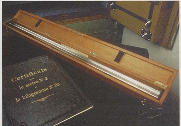
Bild 4: Der Urmeter der Schweiz (Nr. 2) aus dem Jahre 1889
