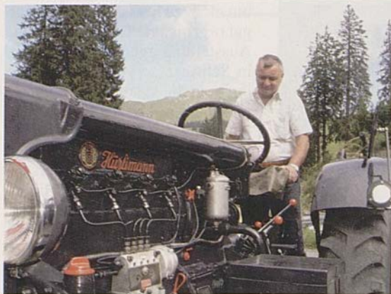
Typ D 100, Baujahr 1946, 5 Vorwärts- und 1 Rückwärtsgang, Hürlimannmotor; 4-Zylinder. Der Traktor wurde in der Landwirtschaft und in der Armee eingesetzt.
