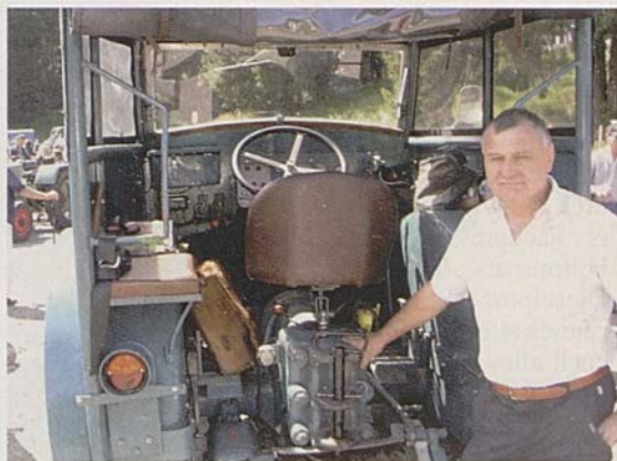
Hürlimann mit hinten angebaute Seilwinde, Typ Industrie. Dieser Typ lief schneller als derjenige in der Landwirtschaft.
