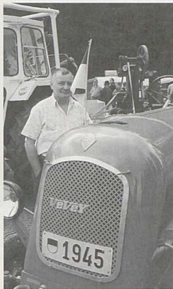
Vevey, Typ LA, Baujahr 1941–43, mit Gegenkolben-Motor
