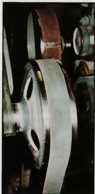
La roue à eau fait tourner axes et courroies.
