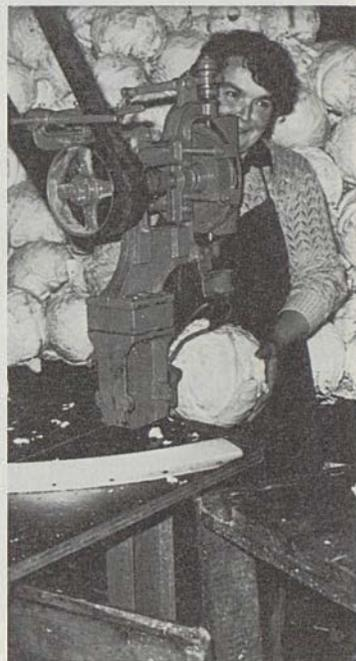
Mit der Strunkbohrmaschine wird der «Storzen» entfernt
